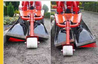
Ideal für die Kantenbearbeitung ist die einfache Schrägstellung der Strahler nach rechts und links.
