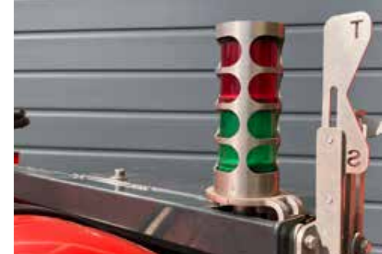
Anzeiger zur Höheneinstellung und Signalleuchten zur Betriebskontrolle der Infrarotstrahler
