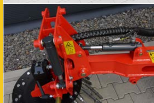
hydraulisch einstellbare Längs- und Querneigung (mechanisch / hydraulisch)
