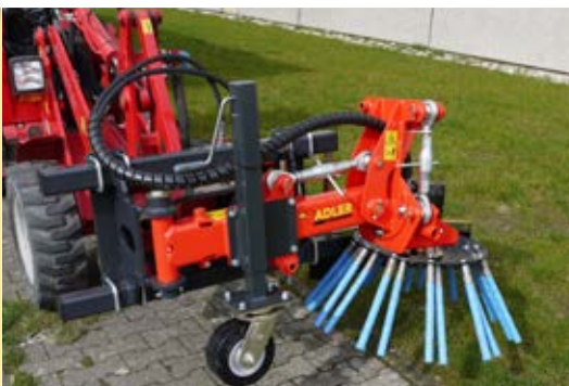
Schwenkarm (mechanisch / hydraulisch) zur Bearbeitung großer Flächen
