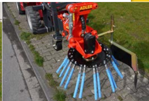
Schwenkarm (mechanisch / hydraulisch) zur Bearbeitung großer Flächen
