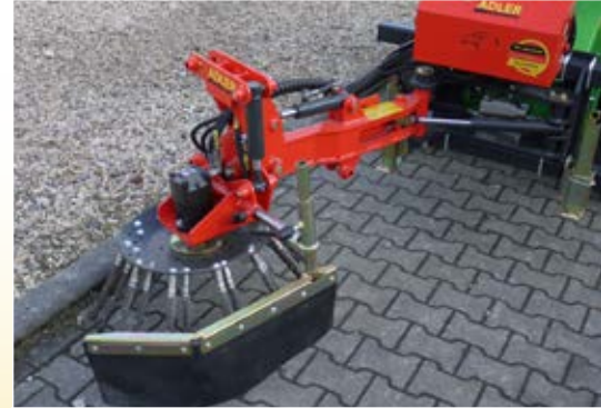
Schwerer Bürstenkopf mit seitlichem Schleuderschutz
