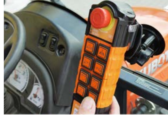
Funkfernbedienung für die bequeme Steuerung in der Kabine
