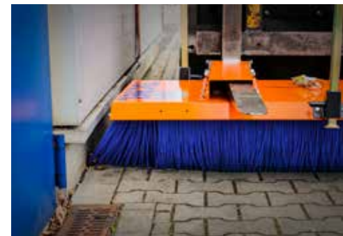
Seitenkehrleiste für randnahes kehren
