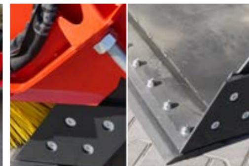
Wechselbare Verschleißmesser unten und seitlich
