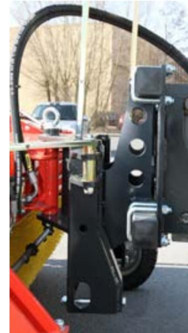
Schwere Universalaufnahme mit Rollenschachtsystem und 3D-Niveaueingleich
