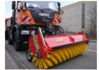
Unimogaufnahme mit Geräteaushebung nach DIN 76060
