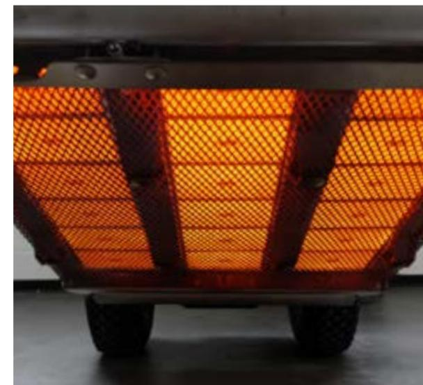
Die Infrarotstrahlung der ca. 1000 °C heißen Keramik-Infrarotstrahler zerstört Zellstruktur und Eiweiß des oberflächlichen Pflanzenmaterials und reduziert die Keimfähigkeit des vorhandenen Samenpotenzials. Bereits nach 1 bis 2 Tagen wird die Schädigung der Wildkräuter sichtbar.
