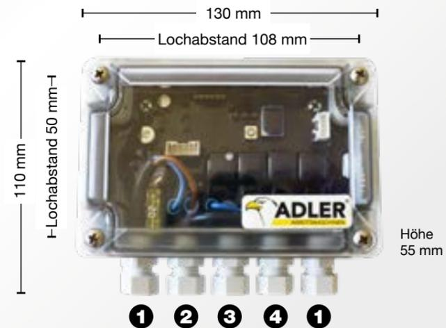
Ausgang 1: z.B. Licht    Ausgang 2: Wasser    Ausgang 3: elektr. Umschaltventil links    Ausgang 4: elektr. Umschaltventil rechts    Eingang 1: 12 V / 24 V
