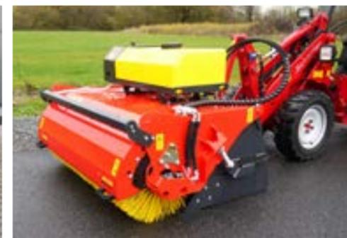
KS 600 im Radladeranbau mit Wassersprüheinrichtung
