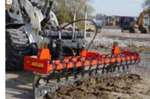
Direktanbau an Schlepper oder Radlader
