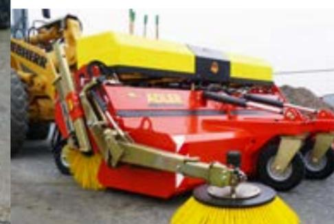
Hydraulisch klapp- und zuschaltbarer Seitenkehrbesen (Ø 900 mm).
