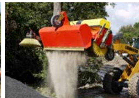
Hydraulische Entleerung des Sammelbehälters
