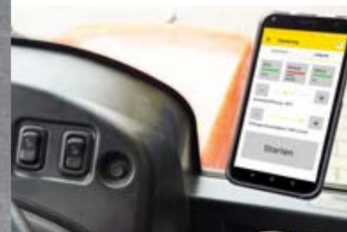
Drehgeschwindigkeit und Ausbringung werden bequem per Smartphone aus der Fahrerkabine eingestellt
