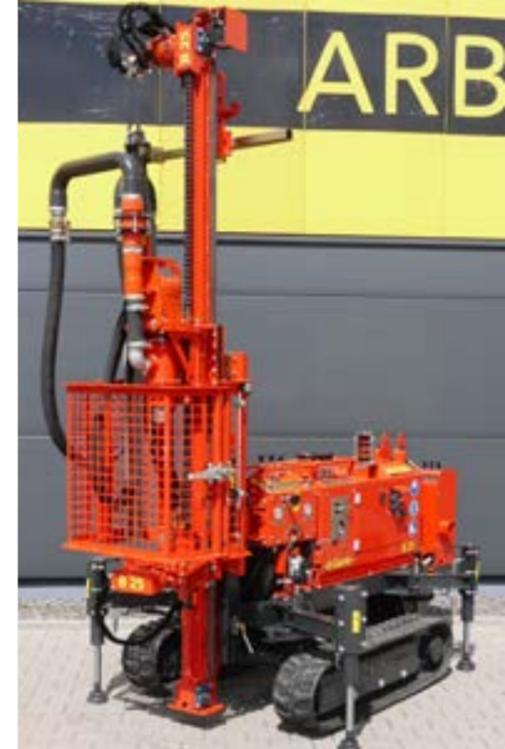
ADLER-Bohrgerät auf ADLER-Raupenfahrwerk
