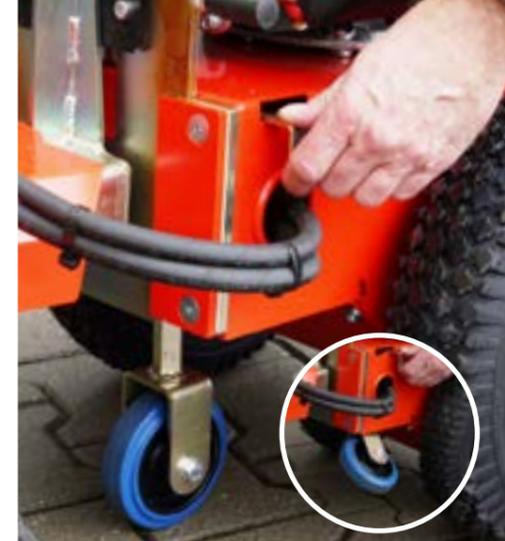
Je nach Einsatzbereich kann das Stützrad bequem ein- oder ausgeklappt werden.
