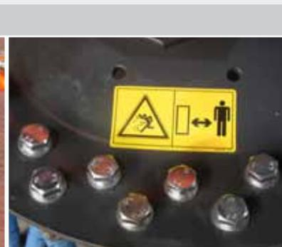
müheloser Wechsel möglich, durch geschraubte Büschel
