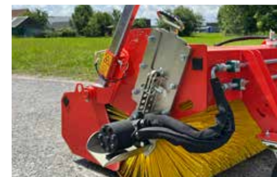
Konstant gutes Kehrergebnis durch schräg angebrachte Bürstenverstellung
