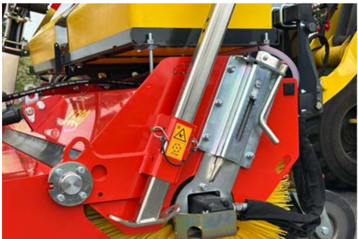
Bequemes Nachstellen der Kehrwalze in Richtung des Sammelbehälters
